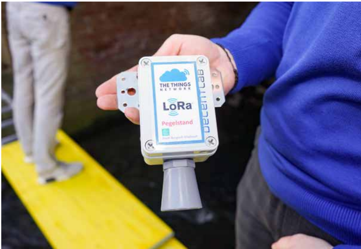
LoRaWAN überträgt Daten geringer Größe bis zu zehn Kilometer weit. Dieser Sensor funkt den Pegelstand der Strunde an Server in der FHDW.
